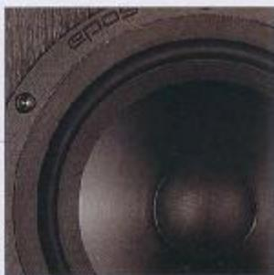
СЧ- и НЧ-динамики очень похожи по конструкции. Внешне их отличает только фазовыравнивающая вставка на оси "среднечастотника" (у вуфера — пылезащитный колпачок). Диффузор диаметром 120 мм отштампован из полипропилена переменной толщины, диаметр каркаса звуковой катушки — 32 мм, корзина отлита из алюминия.
